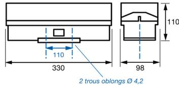
La conception de ce boîtier permet de réaliser un éclairage d'ambiance en plafond très discret (montage rasant avec cadre d'encastrement).
