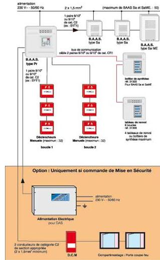
Conçu pour les établissements nécessitant un équipement d'alarme de type 2b, tels que certains établissements scolaires par exemple, ou dans les établissements où l'utilisation d'une temporisation d'alarme restreinte n'autorise pas l'installation d'Equipements d'Alarme de type inférieur.
